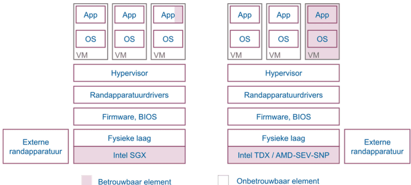
Figuur 1 – Intels SGX-technologie kan worden gebruikt om een proces te isoleren, terwijl Intels TDX- en AMD's SEV-SNP-technologieën kunnen worden gebruikt om hele virtuele machines te isoleren.
